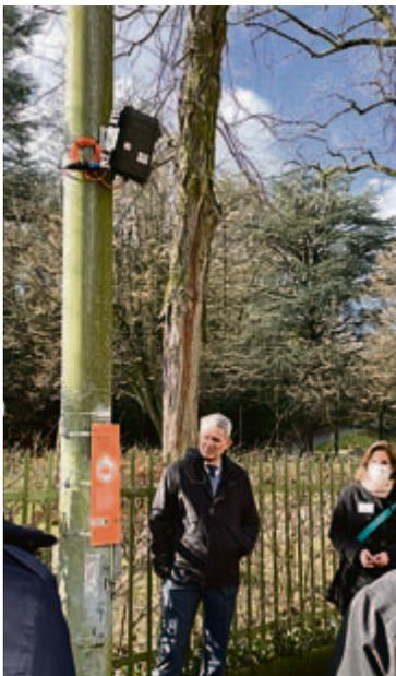
Am Pfosten zwei wird mit obigen Sensoren der Verkehrslärm erfasst.
